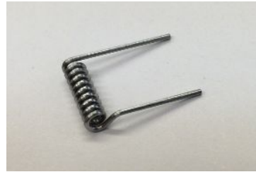
プラズマテック用ストレート GA-001 3.4φ 7.5ターン 幅12.0±0.2 長さ17.0
